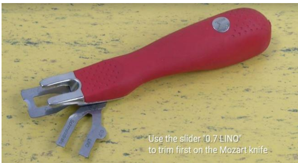
Couteau Mozart avec guide d'arasement linoléum 0,7 mm (coulisseau)
